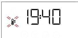
Примечание: во время приготовления можно изменить режим *ручкой выбора* или отрегулировать температуру *ручкой термостата*. Режим включится, только если ручка термостата находится на 0 °C. Можно задать время приготовления, время окончания (только если задано время приготовления) и настроить таймер.
