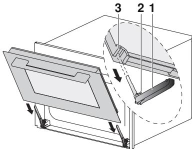
**⚠ Убедитесь, что дверца прибора установлена до упора, в противном случае возможно повреждение прибора при закрывании дверцы.**
