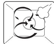
Камера нагревается горячим воздухом. Дополнительный обдув паром обеспечивает более эффективную передачу энергии приготовляемому блюду. Благодаря этому процесс приготовления немного ускоряется, а блюдо становится особенно хрустящим.
