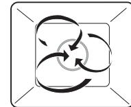
Воздух в камере прогревается нагревательным элементом, расположенным за задней стенкой камеры, и равномерно циркулирует. За счет регулируемой по времени функции открывания дверцы выступающая из приготовляемого блюда влага обильно выводится через равные промежутки времени. Приготавляемое блюдо высыхает медленно.
