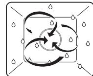
Воздух в камере прогревается нагревательным элементом, расположенным за задней стенкой камеры, и равномерно циркулирует. Влага, выделяемая продуктом, выводится из камеры в минимальном объеме. Влажность продукта сохраняется.
