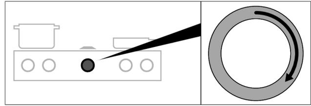
Fig. 5.6 Setting the fan power level
