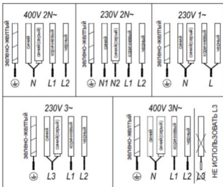
Подключение панели к электросети должно выполняться с помощью рубильника или же, по возможности, штепсельной вилки необходимой мощности, имеющих расстояние между контактами не менее 3 мм. Это позволяет быстро отключать панель от сети в аварийных ситуациях, а также для чистки.
